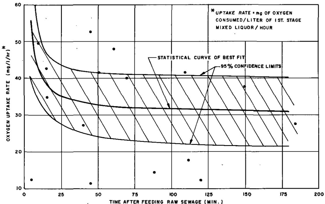
**FIG. 17 OXYGEN UPTAKE RATES OF 1ST STAGE MIXED LIQUOR**
