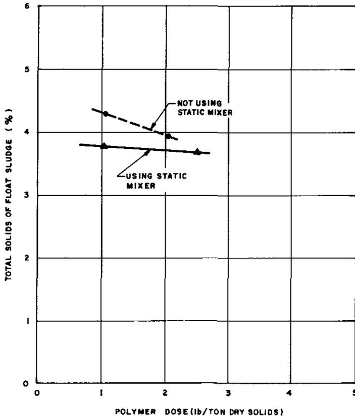
**FIG. 27 EFFECT OF STATIC MIXER ON SLUDGE THICKENING**
